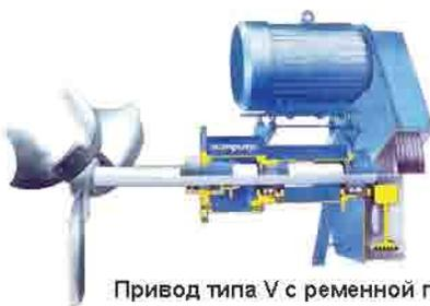
**Привод типа V с ременной передачей**
